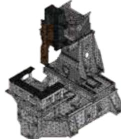
採用 FEA 有限元素分析優化動柱結構，提升剛性與穩定性。強化底座與滑座剛性，確保 XY 軸同動加工時依然維持極致精度，全面提升長時間高精密加工表現。
