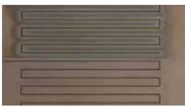
高速無電解AC電源,針對特殊金屬如：鈦合金、鎢鋼等,抑制電解造成的工件腐蝕、氧化發生,大幅減少工件表面軟化層,提高模具使用壽命。
