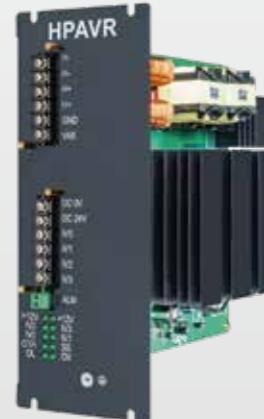
採用新開發IVC高頻交換式穩壓電源，具有穩壓及電壓可調整功能，可使加工時工件的精度穩定，亦將負載與電源隔離，確保整個放電系統安全性。
