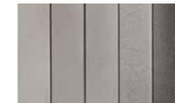
工件材質:SKD11/銅線直徑:0.2 mm/工件厚度:50 mm
