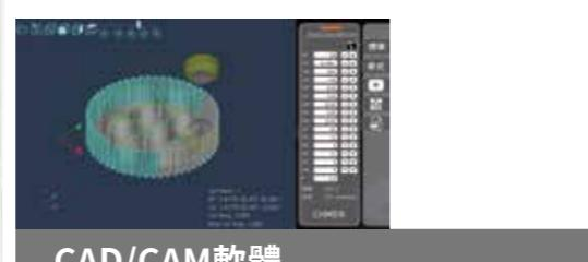
可直接於機台上將 2D/3D 圖檔轉換為加工路徑，無需在外部系統轉檔，並可輕鬆完成加工設定與程式執行。
