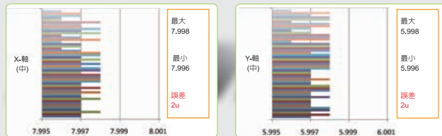
連續50支一刀加工沖子，加工尺寸：8x6mm T=30mm
