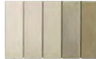
工件材質:鎢鋼 / 銅線直徑:0.20 mm/工件厚度:20 mm
