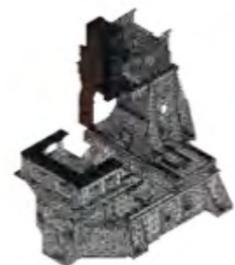
採用 FEA 有限元素分析優化動柱結構，提升剛性與穩定性。強化底座與滑座剛性，確保 XY 軸同動加工時依然維持極致精度，全面提升長時間高精度加工表現。
