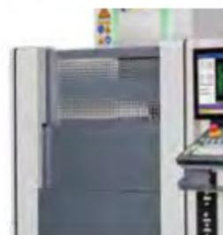
只需輕輕一按，或程式指令，水槽門即可快速升降，搭配自動上鎖功能確保加工過程的安全，大幅提升工作效率，也節省使用空間。
