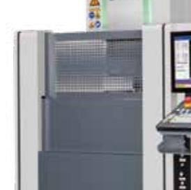
只需輕輕一按，或程式指令，水槽門即可快速升降，搭配自動上鎖功能確保加工過程的安全，大幅提升工作效率，也節省使用空間。
