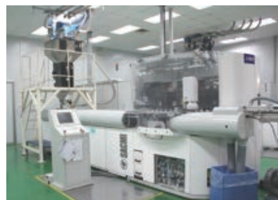
電腦控制塑膠瓶蓋自動生產線一壓模型 Plastic Closure Compression Machine
